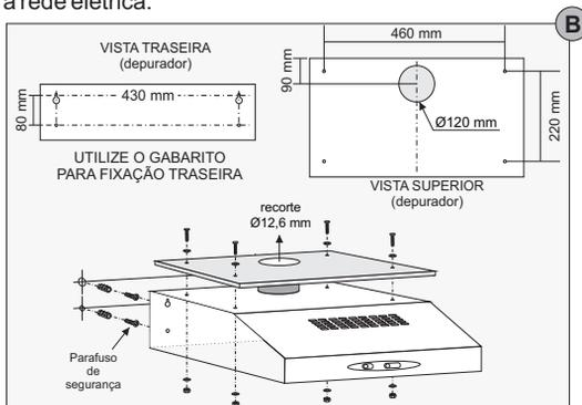
A) Encaixar a conexão para duto no depurador (MODO EXAUSTOR). Caso opte pelo modo depurador, utilizar a tampa plástica que acompanha o produto, para tampar a furação.
