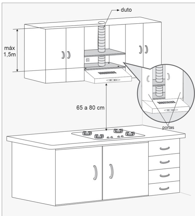
Preparar o local a ser instalado (modo depurador ou exaustor).
