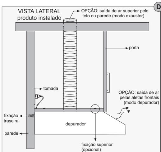
C) Encaixar o duto flexível na conexão após a fixação na prateleira (MODO EXAUSTOR).
