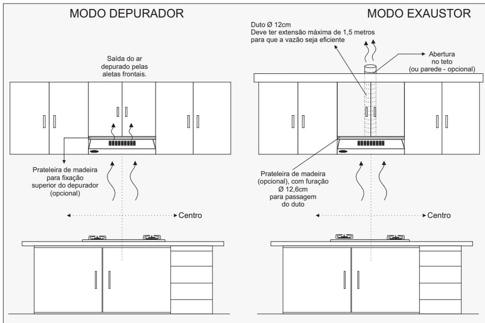
**NOTA:** Para fixação, centralizar o depurador ao fogão. Com uma trena, achar a altura entre o fogão e a base do depurador, conforme indicado neste manual (65 a 80 cm). **O duto não deve ultrapassar 1,5 metros até a saída externa, para que a vazão de ar seja eficiente.**
