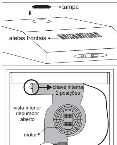
**No modo depurador**, não é necessário utilizar o duto flexível. Tampar a furação para o duto com a tampa que acompanha o produto e virar a chave interna, junto ao motor, para abrir as aletas frontais.
