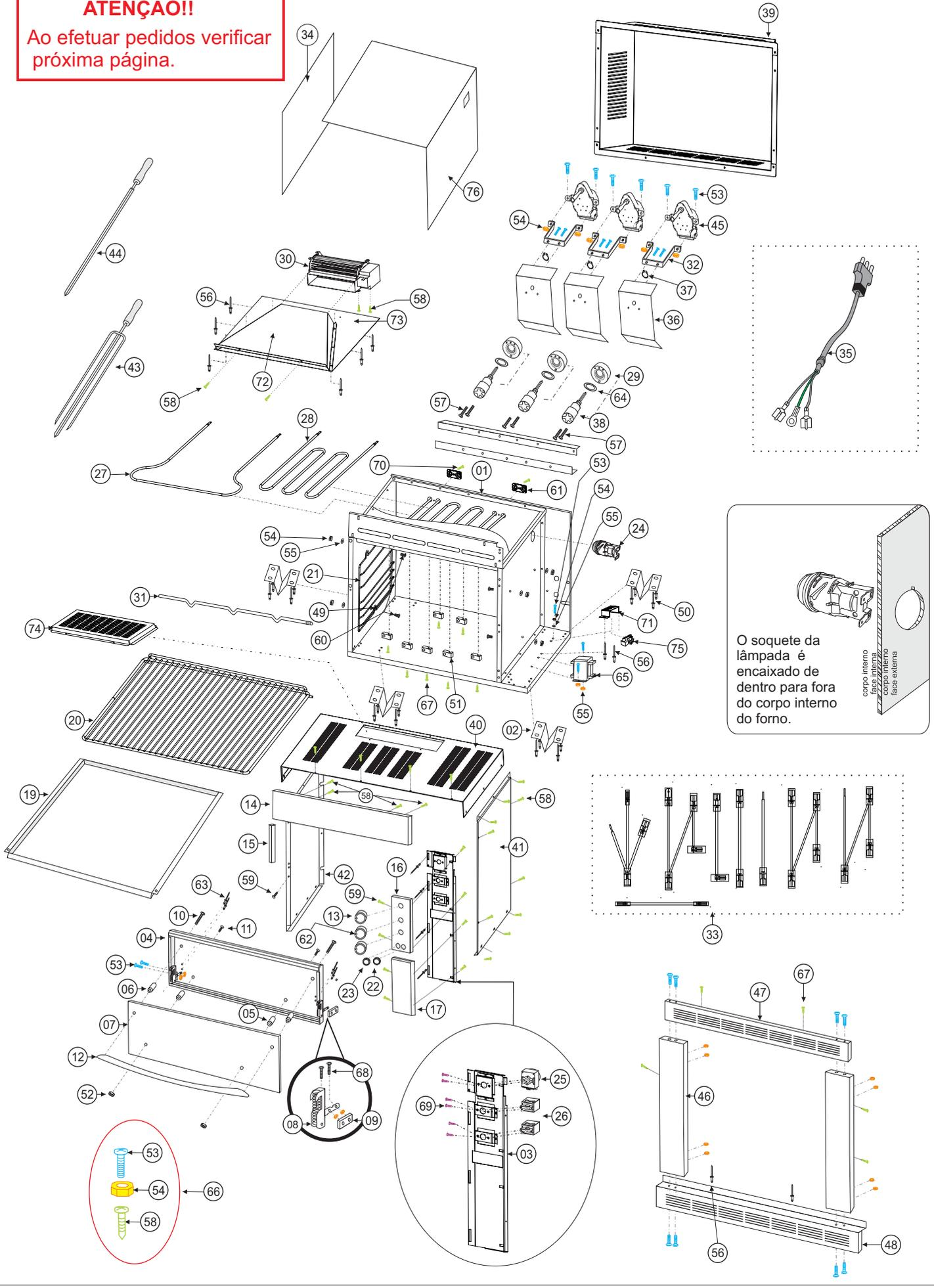
O soquete da lâmpada é encaixado de dentro para fora do corpo interno do forno.
