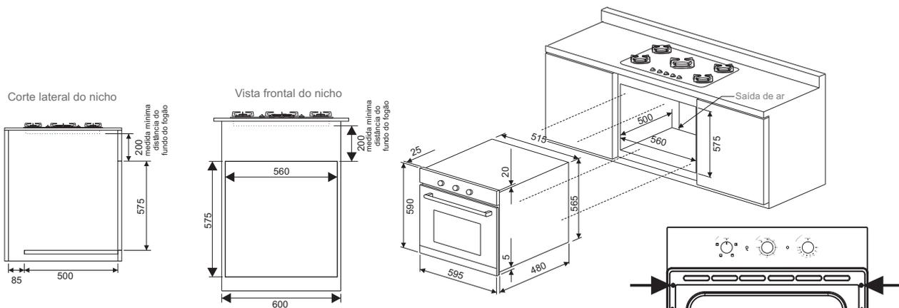
Para prender o forno ao nicho, após encaixado abrir a porta do forno e fixar os quatro parafusos nos quatro furos localizados em torno do quadro do forno.
