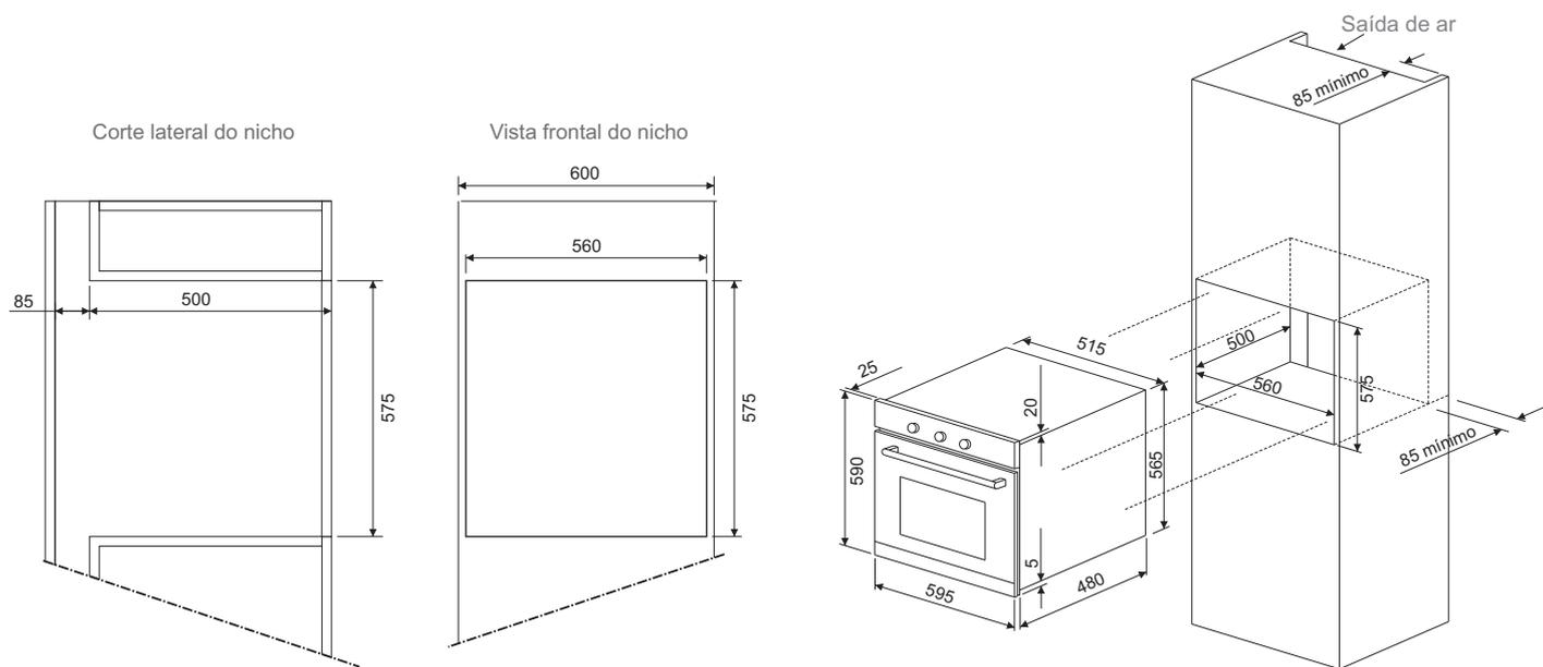
A base de apoio do forno elétrico Fischer Max Gusto no nicho de embutimento poderá ser feita de duas formas, conforme indicado nos desenhos ao lado.
