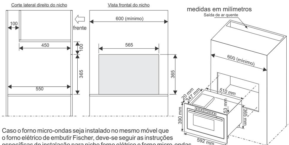
Caso o forno micro-ondas seja instalado no mesmo móvel que o forno elétrico de embutir Fischer, deve-se seguir as instruções específicas de instalação para nicho forno elétrico e forno micro-ondas Fischer, conforme desenhos abaixo.
