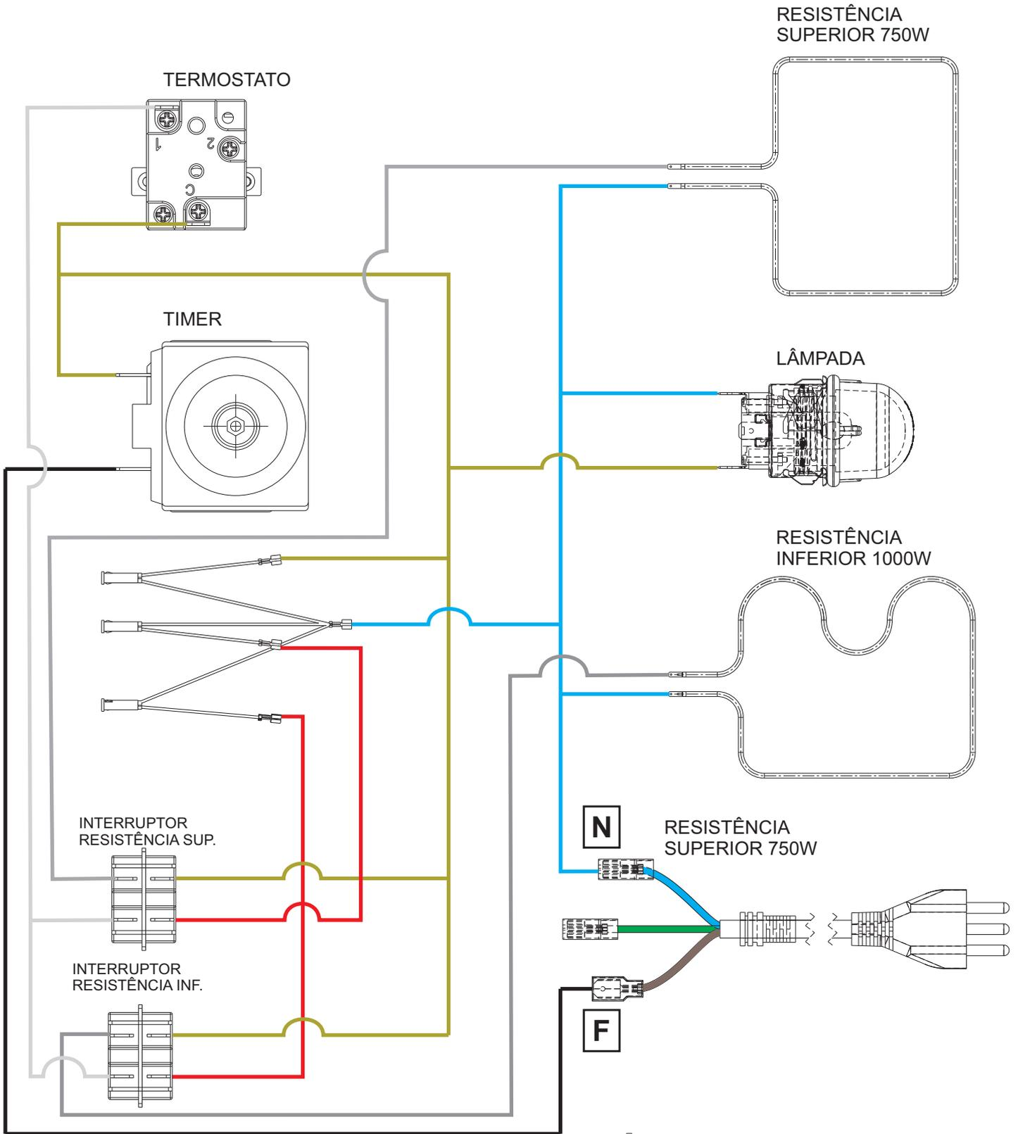
Nova posição de montagem da rede elétrica nos interruptores da resistência inferior e resistência superior.
